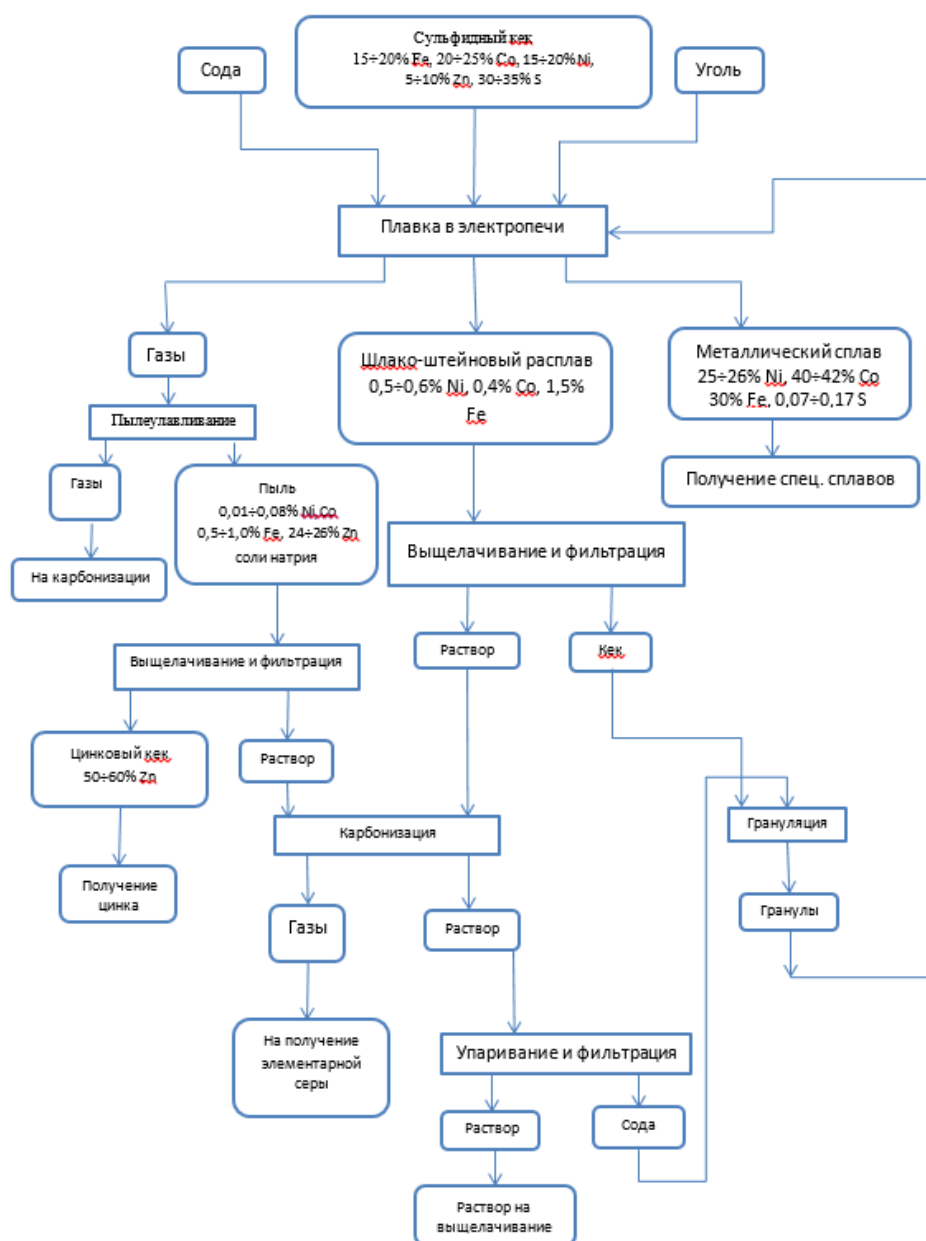
Рисунок 2 – Схема переработки сульфидного кека
